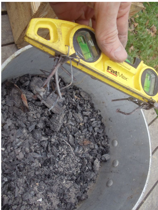
Avec un aimant (ici mon niveau) je récupère les clous de palettes, agrafes de cageottes brûlées
